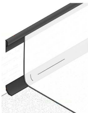
SCHÉMA ŘEŠENÍ SOKLU - VYTAHOVANÝ FABION
