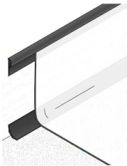
SCHÉMA ŘEŠENÍ SOKLU - VYTAHOVANÝ FABION
