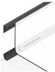
SCHÉMA ŘEŠENÍ SOKLU - VYTAHOVANÝ FABION
