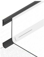
SCHÉMA ŘEŠENÍ SOKLU - VYTAHOVANÝ FABION
