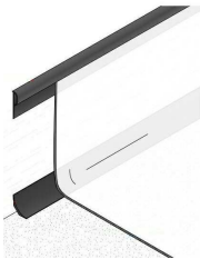
SCHÉMA ŘEŠENÍ SOKLU - VYTAHOVANÝ FABION
