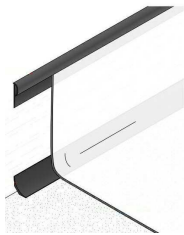
SCHÉMA ŘEŠENÍ SOKLU - VYTAHOVANÝ FABION
