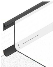
SCHÉMA ŘEŠENÍ SOKLU - VYTAHOVANÝ FABION
