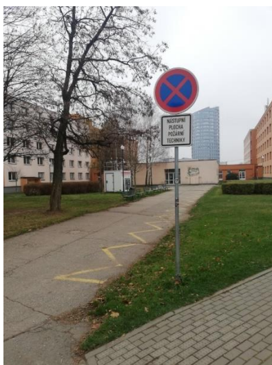
Obr. 1 – označení nástupní plochy požární techniky
